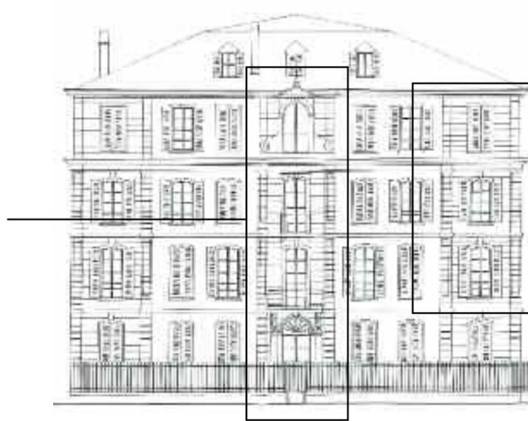
Les portes-fenêtres ouvrent sur un balcon et un balconnet en pierre, dalle et consoles sculptées. Le garde-corps en ferronnerie dessine des volutes et arabesques. La travée encadrée par des pilastres en pierre, se prolonge à l'étage attique par un fronton surmonté d'un édicule en pierre.
