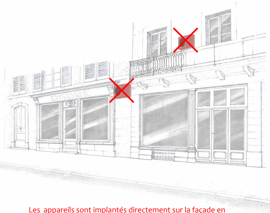
Les appareils sont implantés directement sur la façade en saillie
