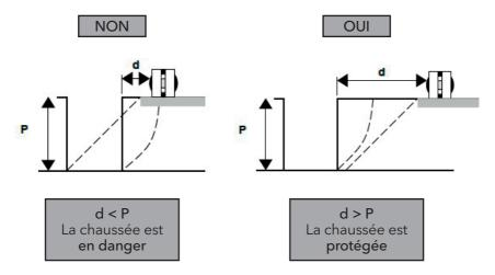
Les tranchées sont creusées verticalement, leur profondeur outre les contraintes d'implantation liées aux raccordements des réseaux sur l'existant et aux croisements de canalisations, doit respecter les conditions de couverture réglementaires
