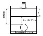
Le matériau d'enrobage recouvre généralement le réseau d'une épaisseur de 10 centimètres. Dans le cas où la hauteur de recouvrement (h) est supérieure à 10 centimètres une justification technique devra être apportée au service gestionnaire de la voirie. Dans ce cas, la première couche de matériaux mise en œuvre aura une épaisseur e telle que e = dmini-h.
