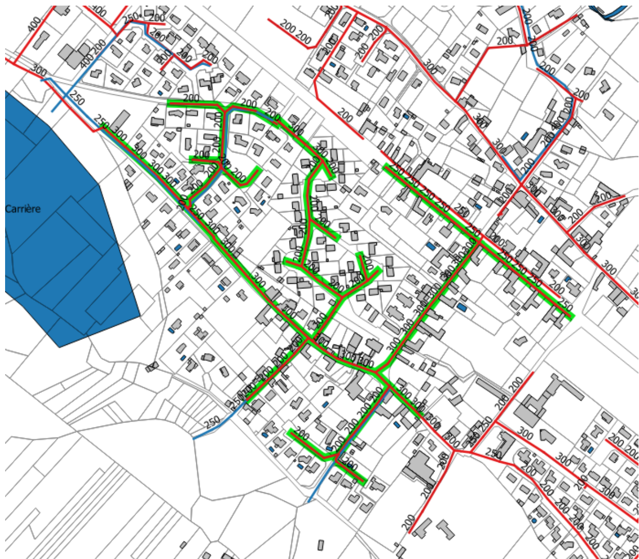
Figure 2 : Localisation des tronçons inspectés au fumigène
