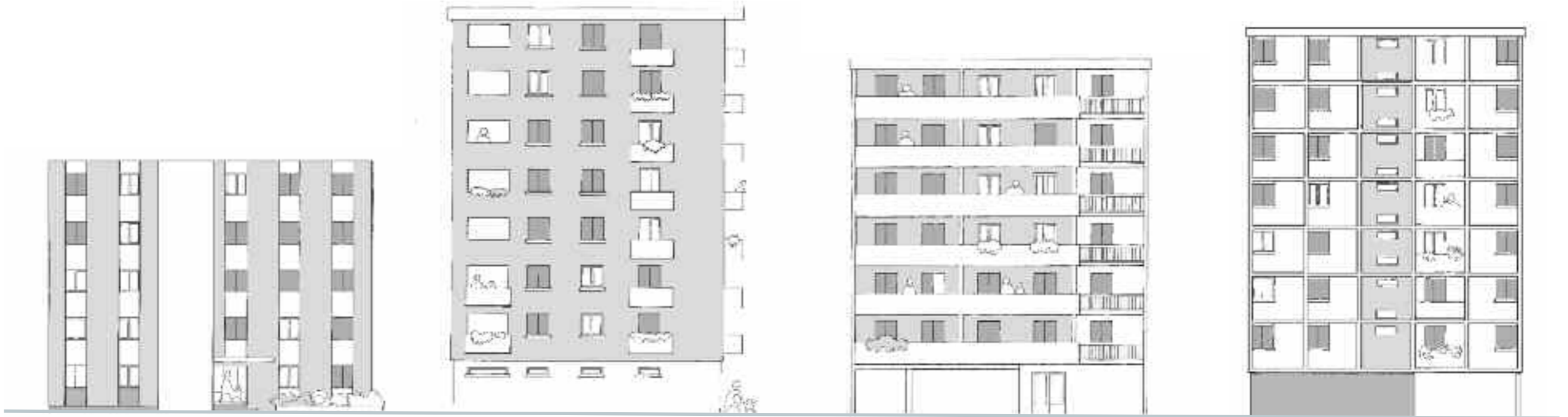
Soubassements foncés - façades moyennes - balcons très clairs - menuiseries foncées
