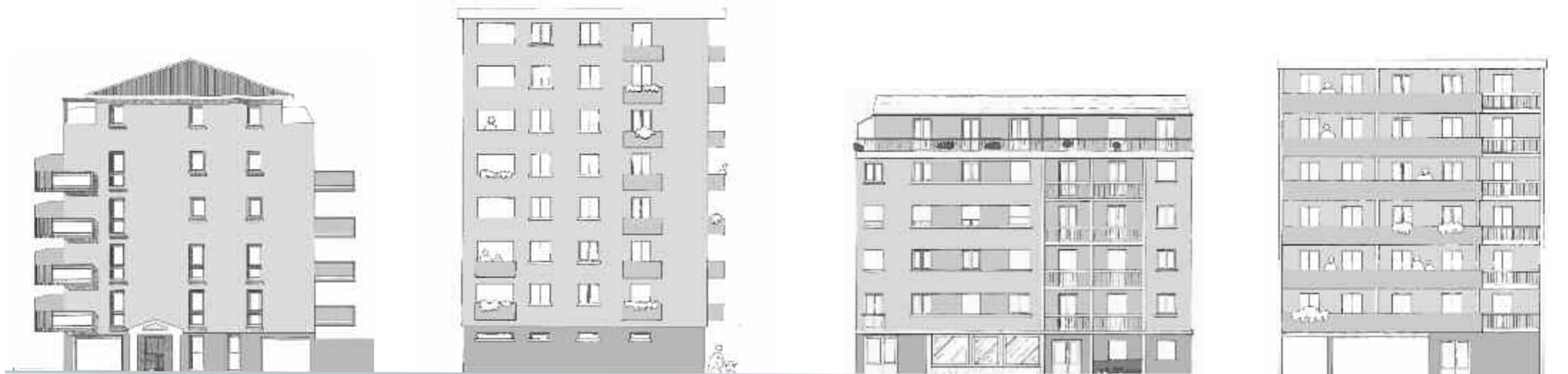
Sur un soubassement foncé, une façade moyenne et des balcons ou des fonds de loggias foncés
