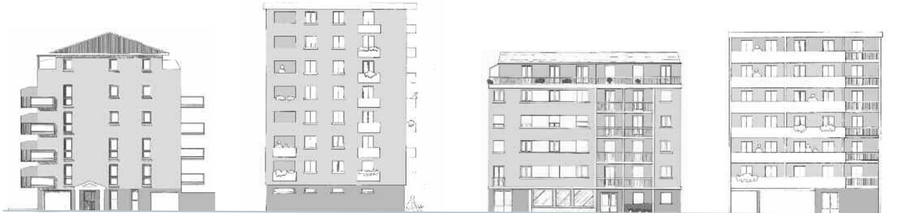
Sur un soubassement foncé, une façade moyenne, des balcons, allèges claires et une verticale foncée (fond de loggias).
