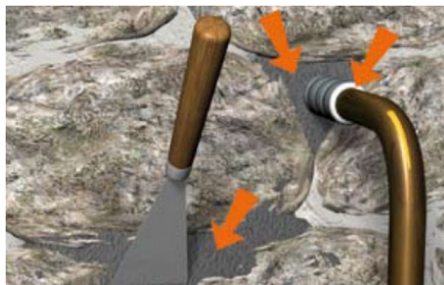
Situation après travaux de colmatage
