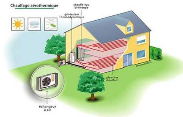
Figure 28 : Fonctionnement Aérothermie Air / Eau (Source : <https://guide.devisconseil.com/pompe-chaleur/aerothermie-air-eau>)
