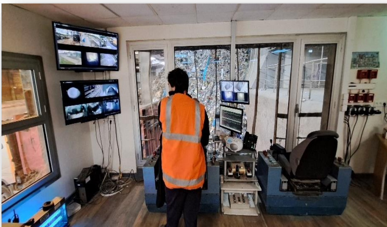
UVE de Lescar : poste de commande et fosse de réception des OM
