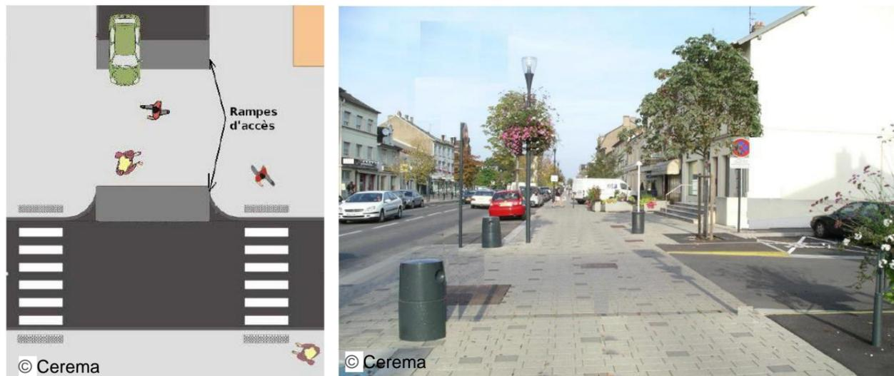
Schéma et exemple de trottoirs traversants
