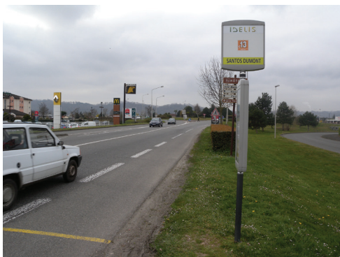
Aucune perméabilité piétonne dans la zone (absence de passage piéton, arrêt tc non accessible PMR, absence total de cheminement piéton...)
