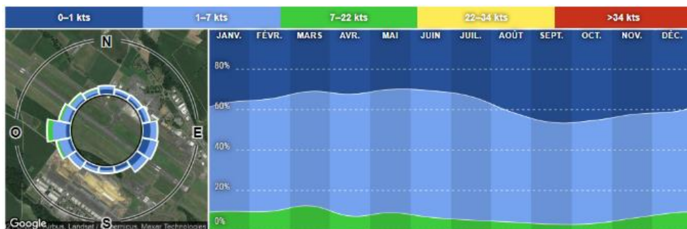
Figure 14 : Direction et répartition de la force du vent à la station Pau-Uzein
