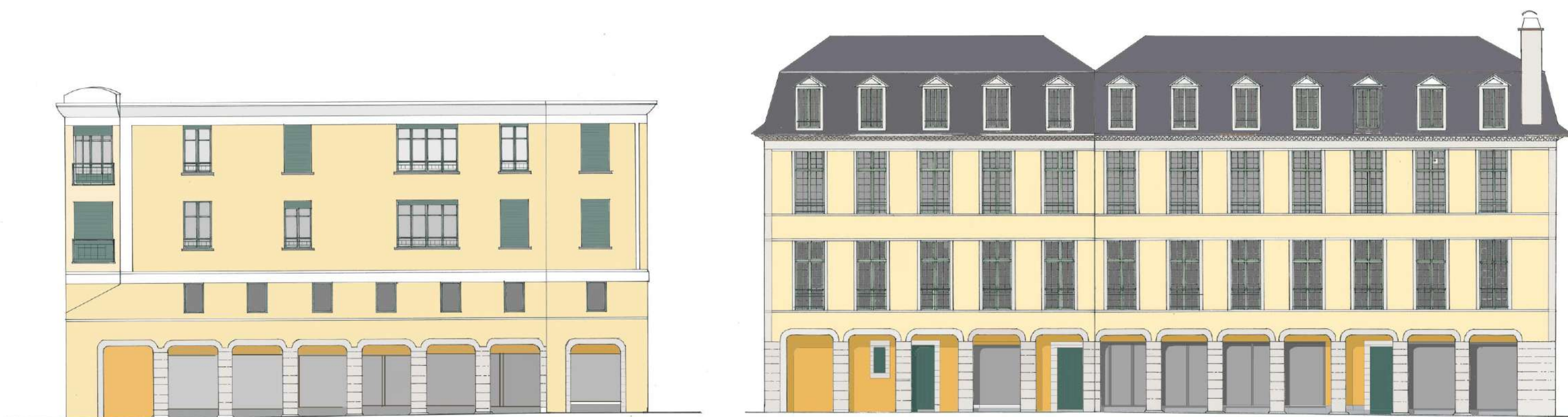
Façades: 1020-Y20R, menuiseries:6020-G30Y
