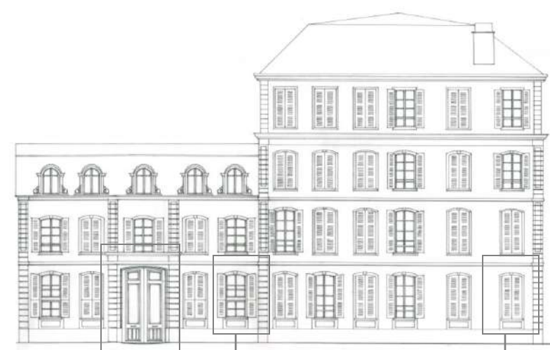
Arc surbaissé, claveaux en pierre de taille
