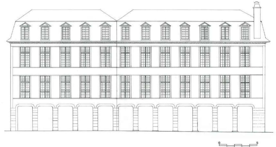
5, place Reine Marguerite, grande façade et son retour construits pour border la place : le soubassement est marqué par les arcades, les étages sont soulignés par les bandeaux en pierre. Les fenêtres sont à croisée en partie haute, en bois peint et petits carreaux.
