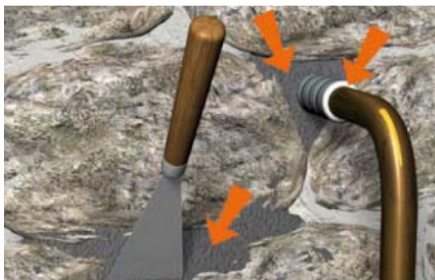
Situation après travaux de colmatage
