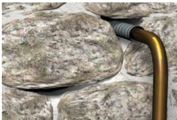
Situation initiale avant colmatage
