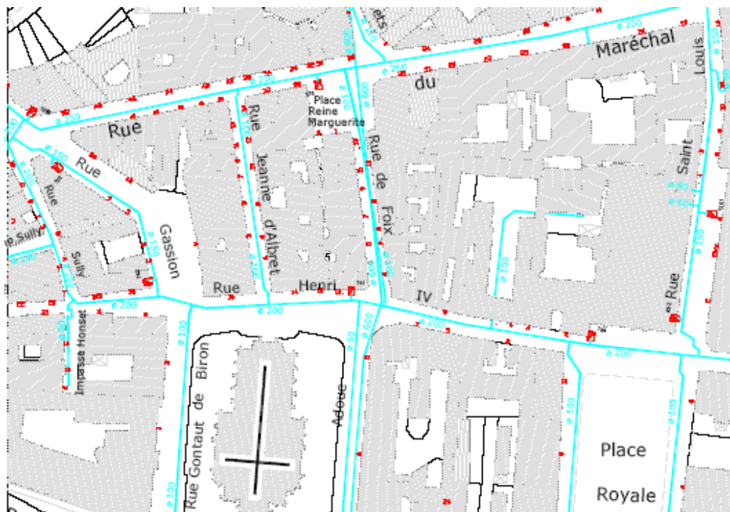
Figure 13. Vision SIG du réseau d'eau potable
