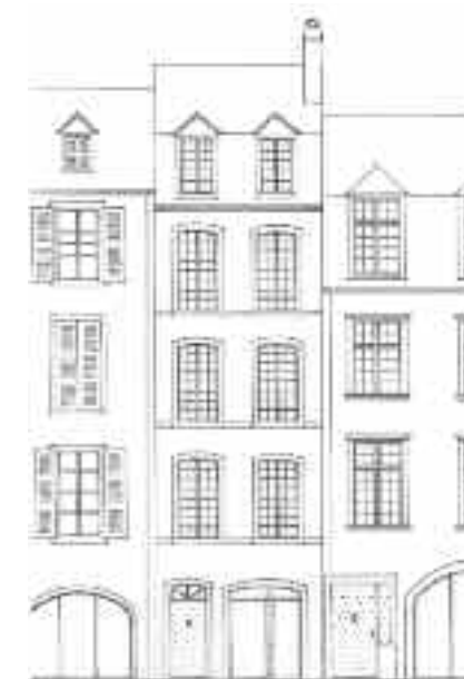
30, rue du Maréchal Joffre : façade étroite et haute, étages soulignés par les bandeaux en pierre, menuiseries de fenêtres allongées et à petits carreaux.
